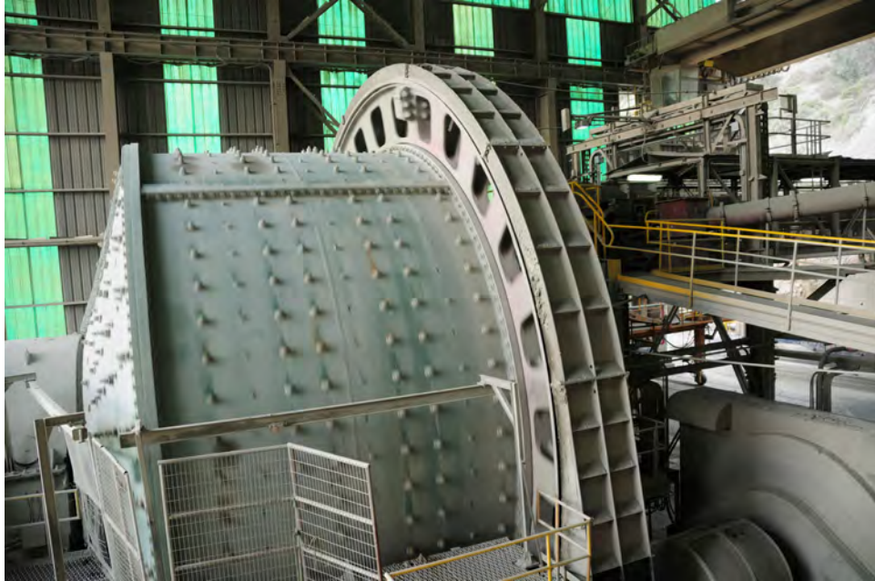
Figure 10. Tout moteur à induction entraînant une charge importante comme le moulin à billes montré ci-dessus nécessite une quantité importante de puissance réactive pour fonctionner. L'utilisation de la correction du facteur de puissance distribuée permet d'éviter que la grande puissance réactive requise par le moteur n'affecte le facteur de puissance de l'application industrielle.
